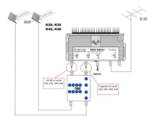
Il filtro FF004F permette di miscelare i segnali dei mux RAI e di tutti gli altri mux quando sono ricevuti da 2 antenne (direzioni) distinte.
